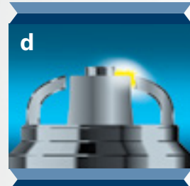
Electrodo lateral – superficie de aislador – electrodo central
