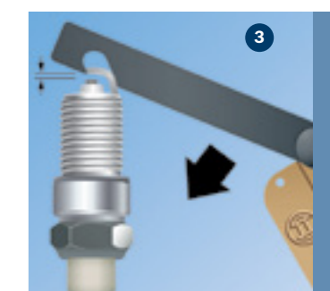
3 Si es necesario, aumentar la distancia entre los electrodos.
